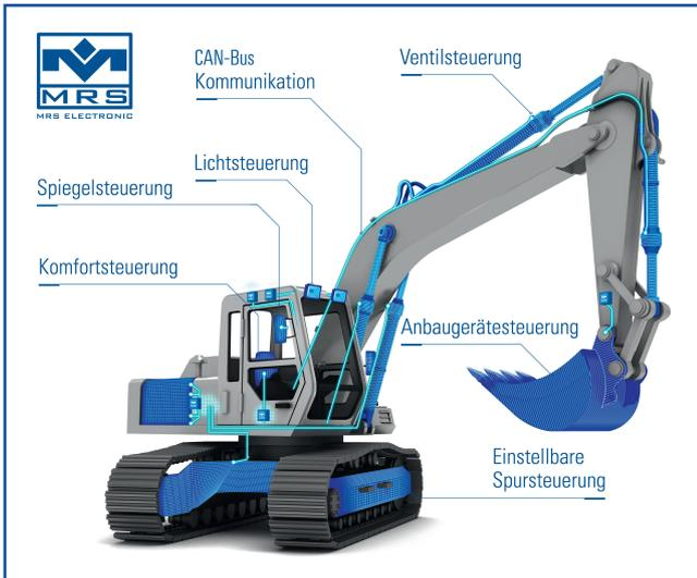
**Bild 1: MRS Electronic bietet ein breites Portfolio an wetterbeständigen und strapazierfähigen Relais, Gateways und Steuerungen an, die bereits erfolgreich in zahlreichen Baumaschinen eingesetzt werden.**
